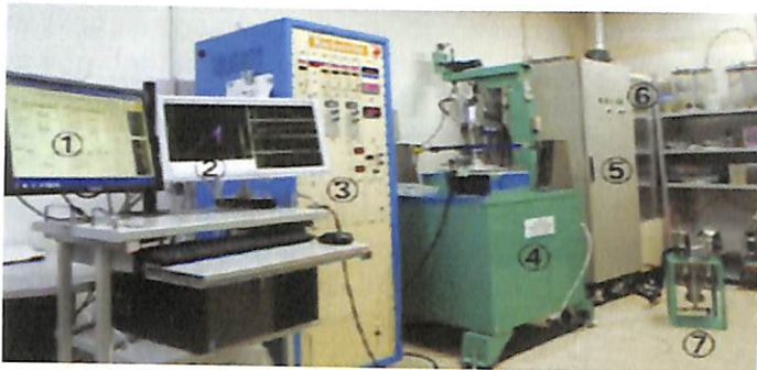
Hình 3: thiết bị cất vòng không thoát nước ở áp lực cao (ICL-2)
