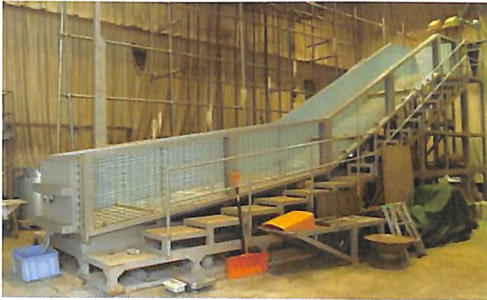
Hình 6: mô hình thiết kế hệ thống máng trượt dựa trên tính chất mẫu đất ở khu vực Hải Vân và hệ thống phun mưa nhân tạo
