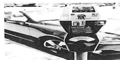
Hình 7. Điểm đỗ xe sử dụng máy tính thời gian và tính phí theo thời đoạn
