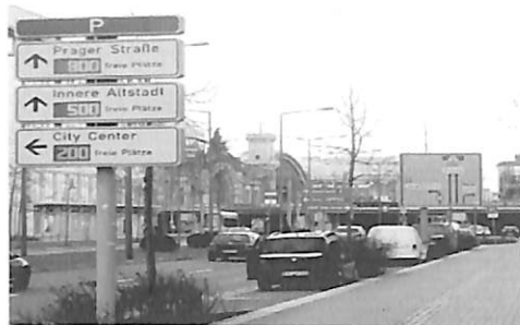
Hình 10. Hệ thống thông tin thời gian thực về nhu cầu và hướng dẫn đỗ xe đô thị [3]
