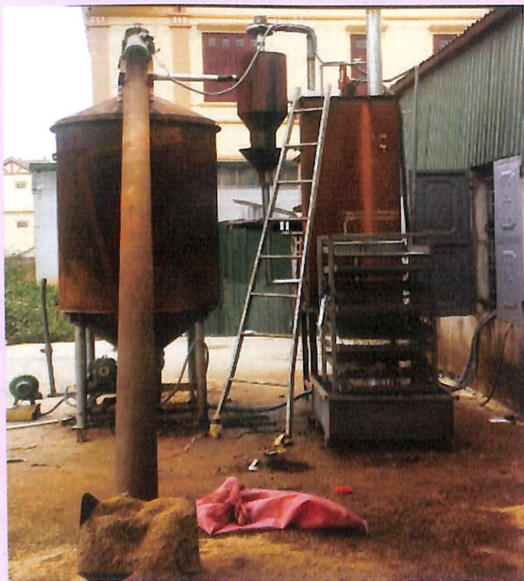
Hệ thống lò đốt vỏ trấu tự động tạo than sinh học (Biochar)
