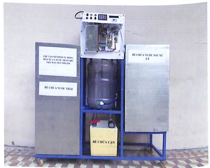
Hình 9. Cấu tạo mô hình tự động hóa xử lý nước thải dệt nhuộm.
