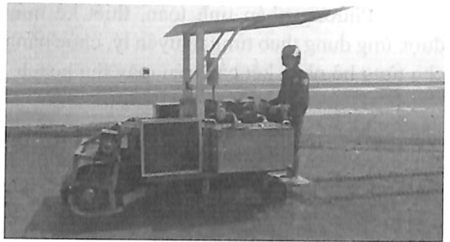
Hình 6: Ứng dụng máy thu hoạch nghêu tại Cần Giờ, TP. Hồ Chí Minh
