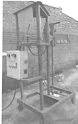
Hình 4. Thiết bị thử nghiệm khoan (thiết kế Inventor [5]):
