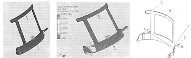
Hình 2. Kiểm tra bền, các bước gia công chi tiết tấm đỡ lưng.
