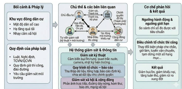
Hình 2. Khung giám sát môi trường thi công dự án hạ tầng kỹ thuật tại khu đông dân cư
