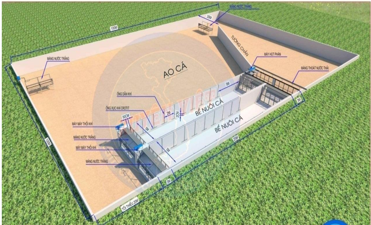
Mô phỏng thiết kế 2 bể nuôi (diện tích 125m 2 ) trong ao nuôi (diện tích 10.000m 2 )
